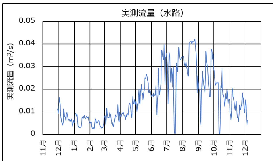
図 14 実測流量 (水路) = 集落の取水量
