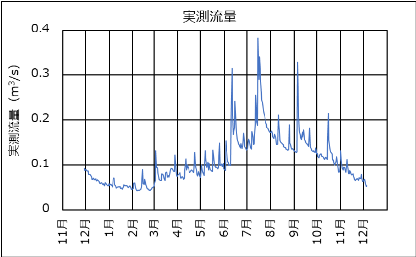
図 11 水位データから換算した実測流量
