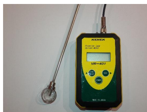
図 7 プロペラ式流速計 VR-401
