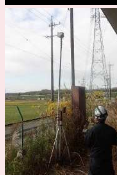
■点検ロボットカメラ
