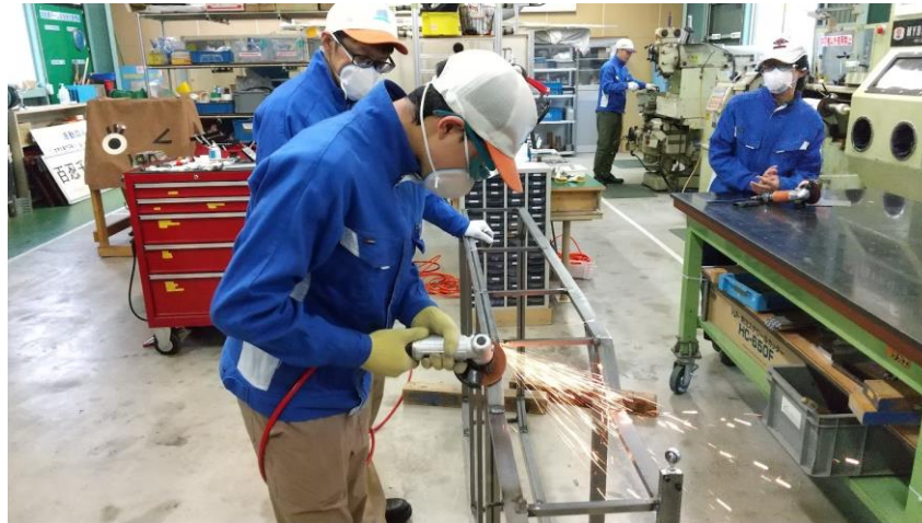
完成に向け、グラインダーで仕上げ
