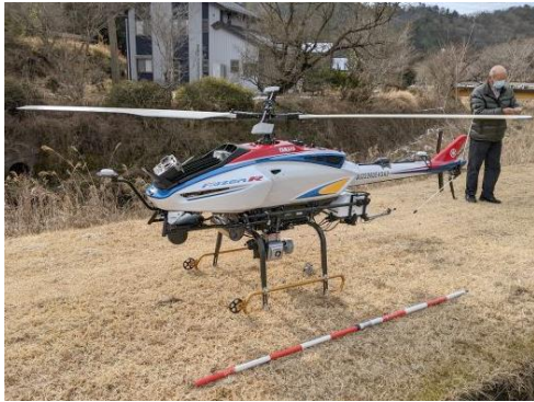
レーザー測量機器を搭載した小型無人ヘリ
