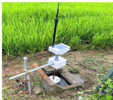
水管理センサー及び給水バルブの試験導入による遠隔での水位調整及びデータ管理
