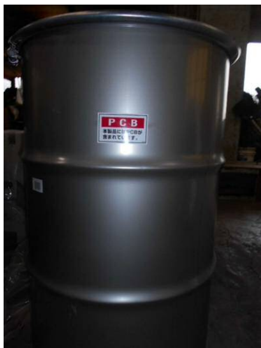
発見された工場内の倉庫にて ドラム缶に入れて保管されている例
