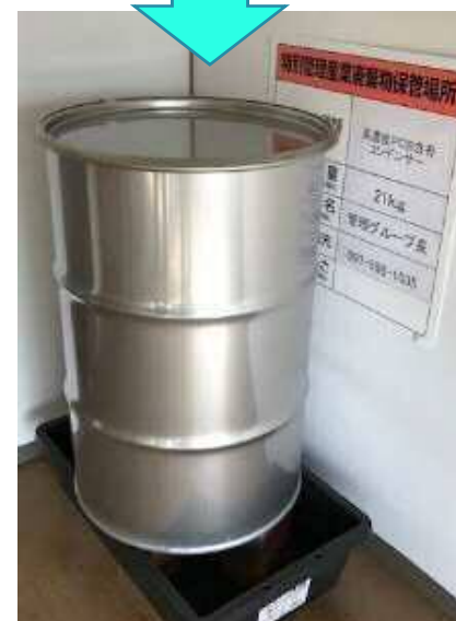
二重の腐食・漏洩防止措置を施し、 旧社宅居室に保管されている例 (現在はトレイからドラム缶に移して保管中)
