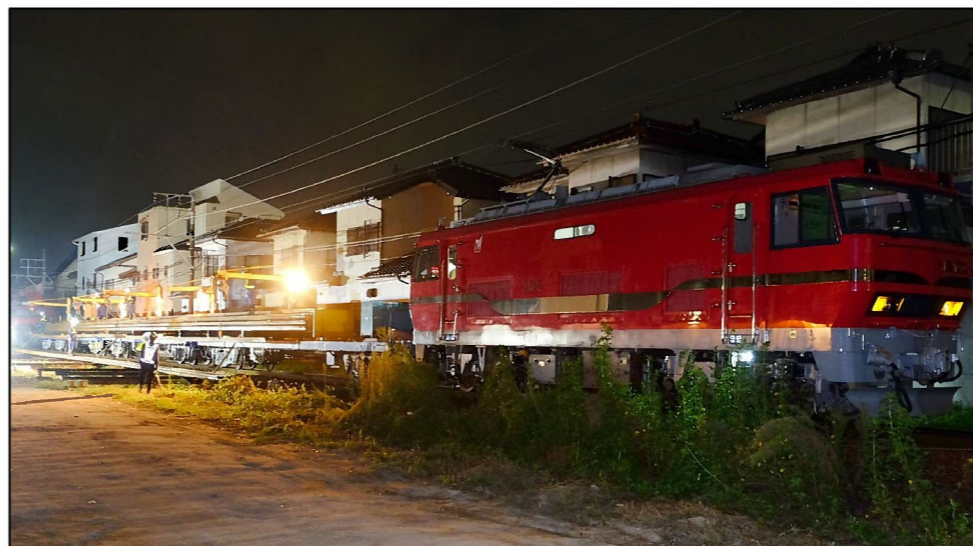
名鉄の電気機関車が入線し、レールの搬入を行いました。レール置き場からはモーターカーでレールを運搬します。
