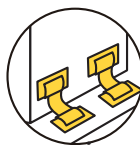
ストラップ式を用いて 電子レンジを固定した例
