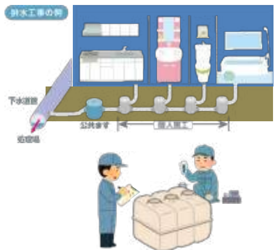
図 5-2 排水工事・浄化槽の管理
