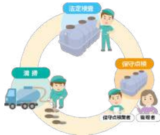
図 5-8 浄化槽の維持管理
