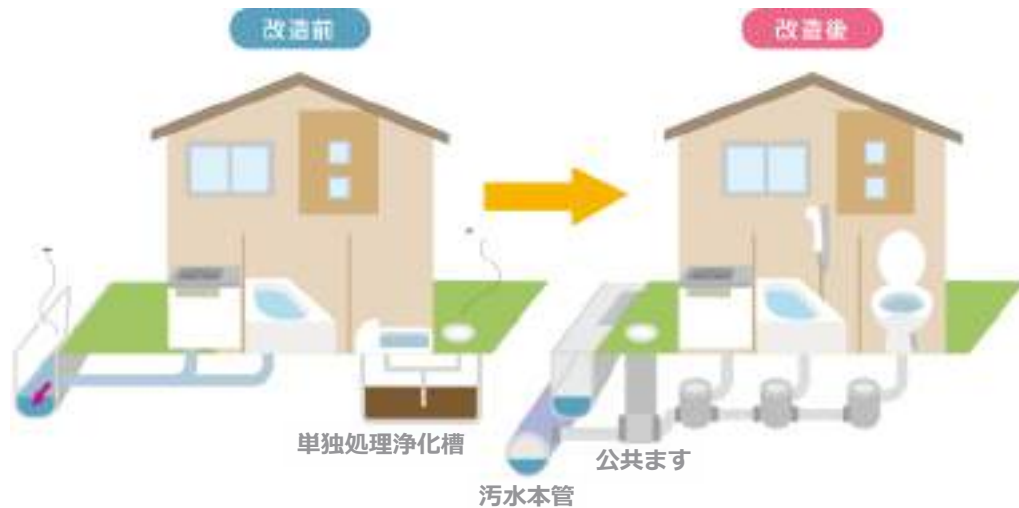
図 5-6 公共下水道への接続
