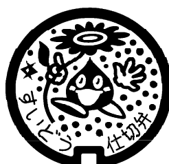
鉄蓋（ \phi 75 ～用） 『仕切弁』
