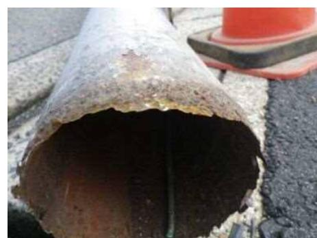
写真-6.8.2 腐食した照明柱基部断面
