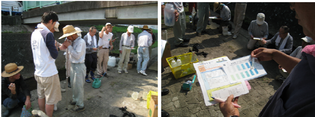
図 2-11 川しらべの様子(左：透視度の測定、右：アンモニア性窒素の調査)
