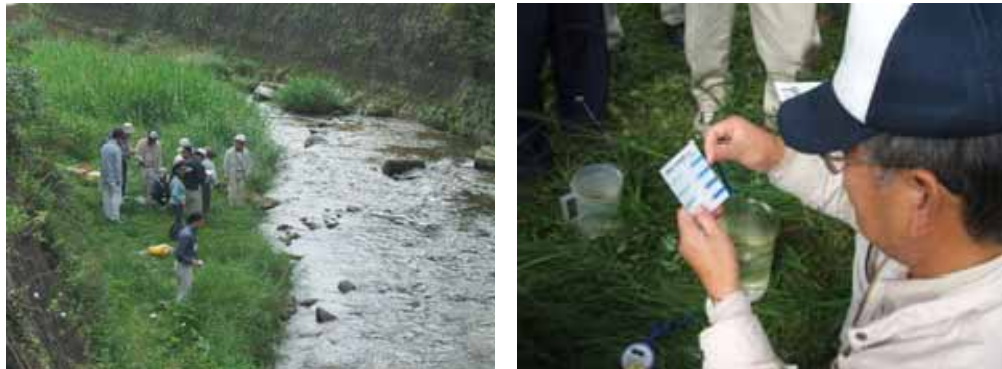
図 2-14 川しらべの様子(左：川へ降りる様子、右：アンモニア性窒素の調査)
