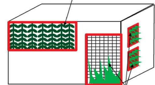
補助資材、植栽基盤等の資材が外壁部分に設置される場合は、その資材または植物に覆われている部分の壁面に対する鉛直投影面積を緑化施設の面積として算定。
