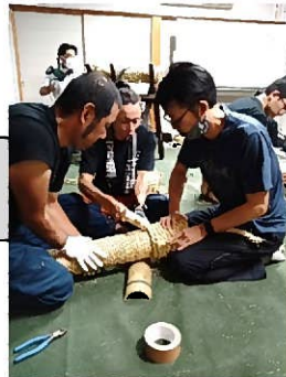
③筒の強度を確保するため、縄を2重に巻きます。
