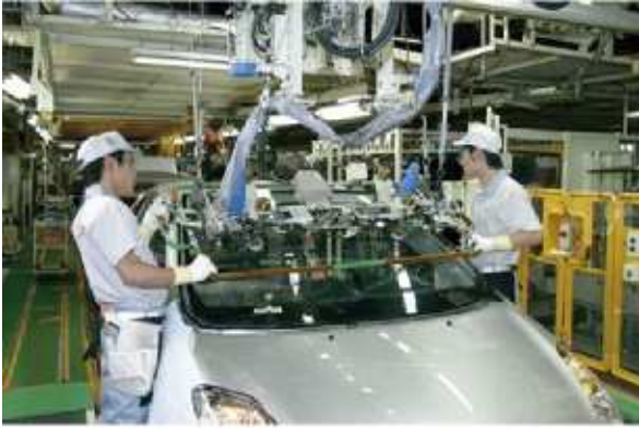
⑦-4. ガラス取付け
