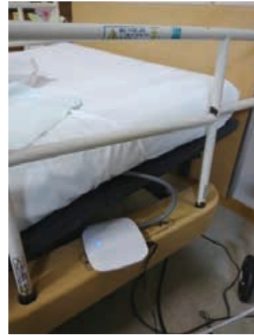
マットレスの下に非接触型センサマット
