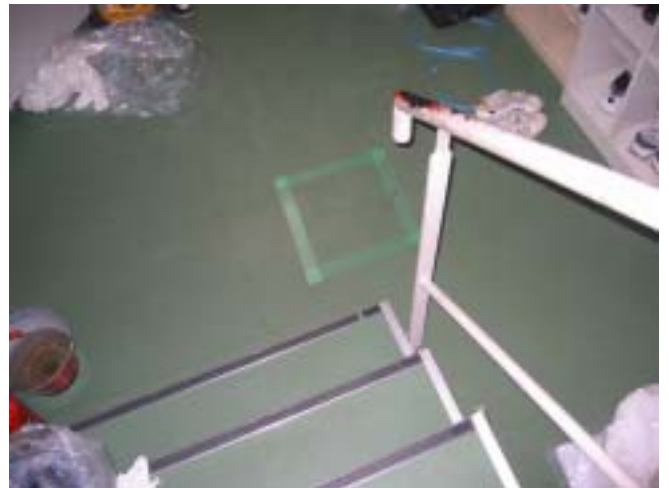
一般管理区域の床の PCB 汚染状況を把握する拭取り調査箇所
