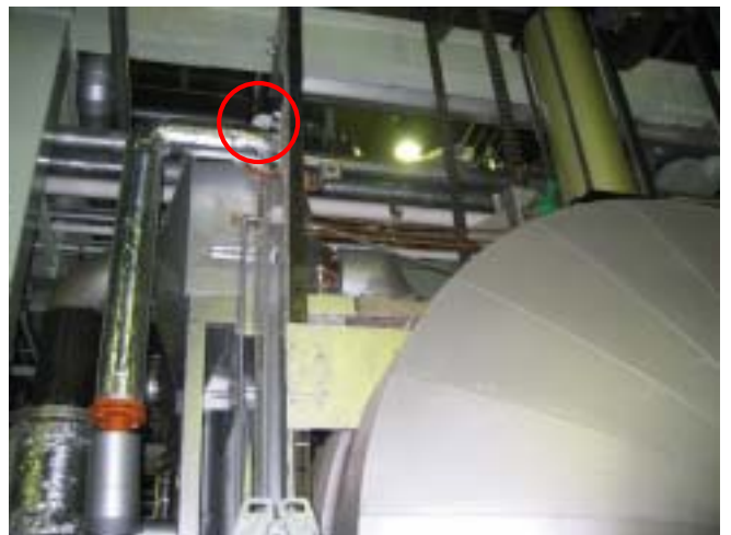
真空加熱炉の熱交換器への追加圧力計追加による安全管理対策
