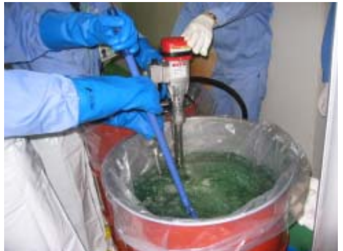
洗浄油による PCB 抽出作業
