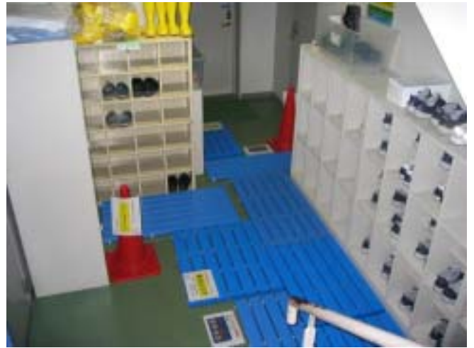
22 保護具による汚染拡大の防止対策（すのこの追加：すのこの上は素足で移動する）
