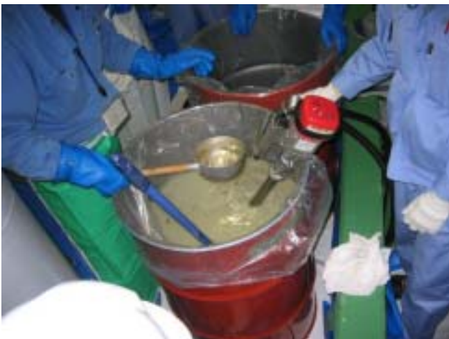
抽出後の洗浄油の回収作業
