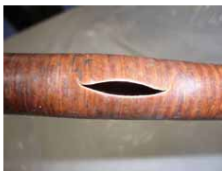
破裂した銅チューブ
