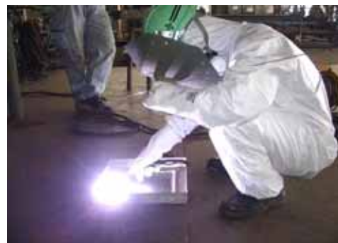
防護服に遮光マスク溶接検証
