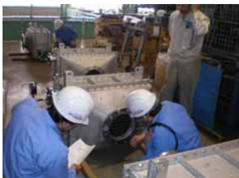
新しい熱交換器工場立会検査
