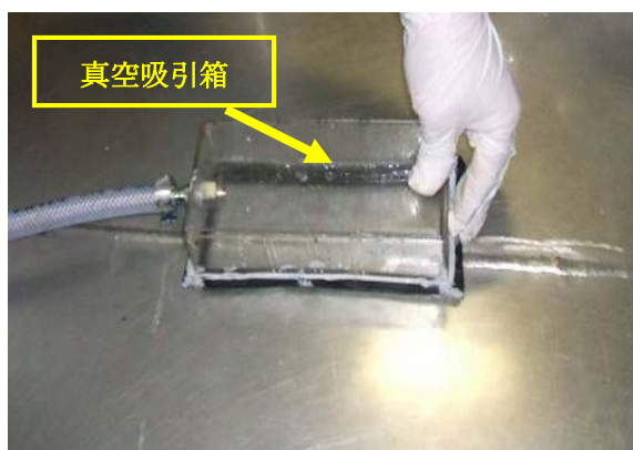
真空発泡漏れ試験
