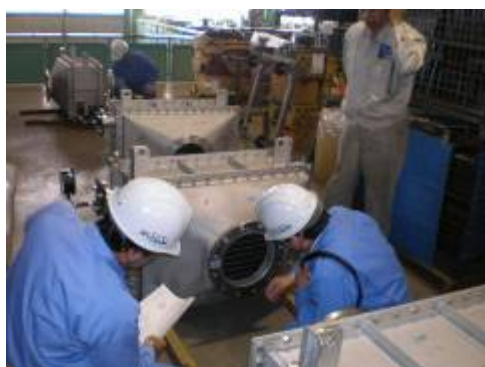
新しい熱交換器工場立会検査
