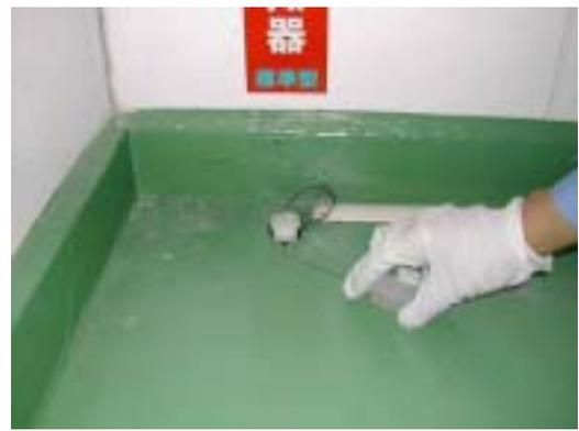
非接触光反射式漏洩検知器
