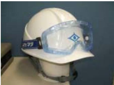
状況：他事業所でのトラブル報告の展開：所内でフランジを取り外したとき、液が飛散した事例を踏まえ
