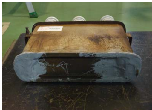
コンデンサの補修例
