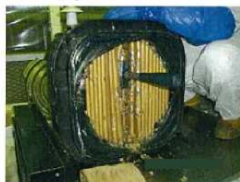
手解体作業の様子(特殊な形状のコンデンサ) (作業環境の悪化により、現在では同作業は実施していない。)
