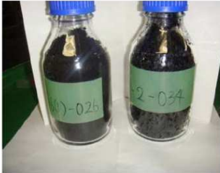
サンプルとして採取したPCBを吸着した粉末活性炭
