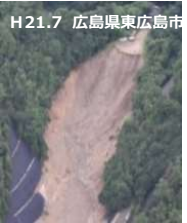
崩壊された土石の崩落 死者1名、重傷者1名、 住宅被害1棟
