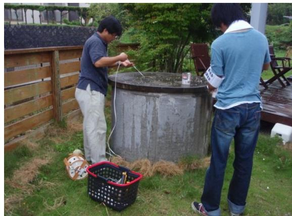
地下水：地下水の水位と水質の測定
