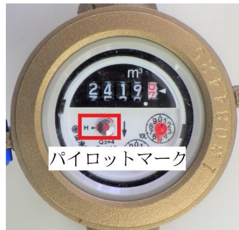
水道メーター
