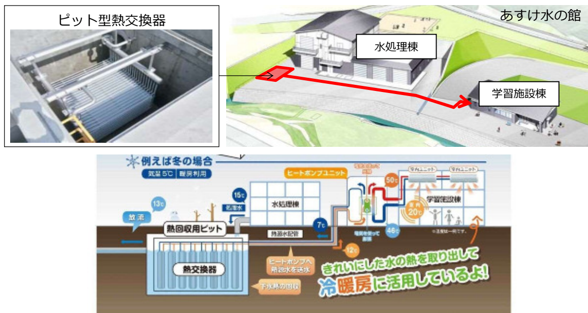
あすけ水の館における下水熱利用実証事業の概要
