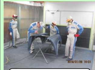
フェンダー塗装作業
