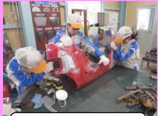
フェンダー修復作業
