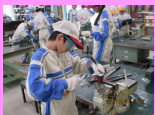
鉄板曲げ実習
