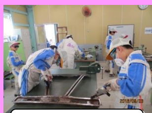
ボンネット修復
